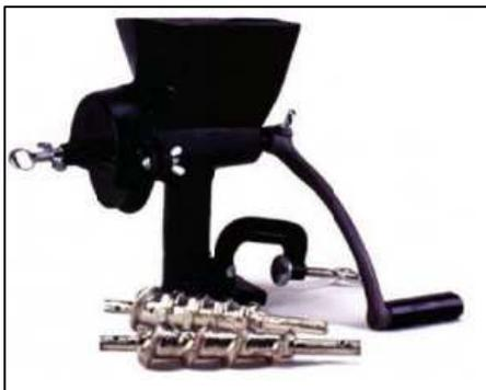
Es un equipo ajustable para graduar la molienda y la maceración y admite cambio de tornillos y dientes para maceración en seco o húmeda.
