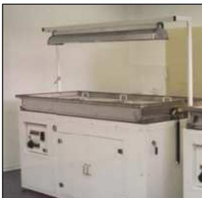
Está destinada al laboratorio, para que la semilla alcance el punto de germinación adecuado. Esta mesa posee control automático de temperaturas y de periodos de luz, está cubierta de cristal para evitar la evaporización. Posee una reserva de agua la cual debe ser controlada cada 3 días. Tiene 3 placas, para colocar los papeles filtro para los ensayos. El agua de la reserva mantiene estos papeles húmedos constantemente. Costo \$344.256,40.
