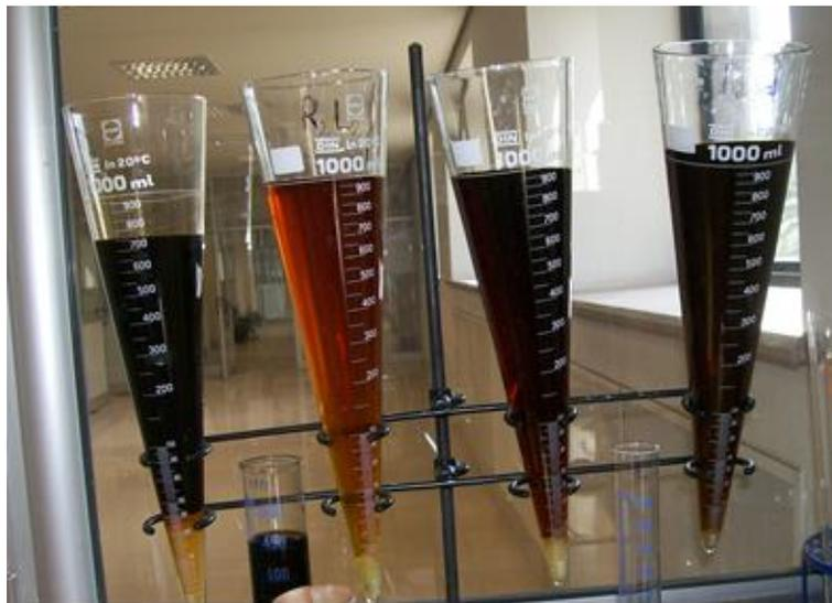
**Figura 8. Coloración del efluente proveniente de la producción de aceitunas en conserva.**
