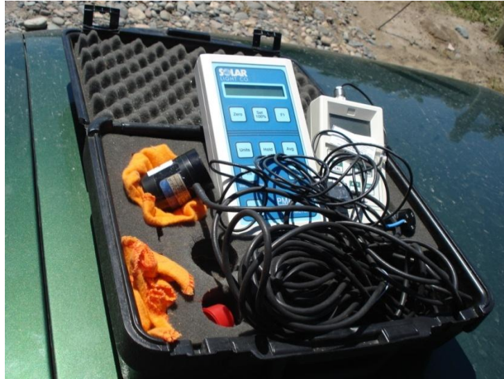
Figura 2.1 Radiómetro y detector para UV-B (PMA2200 y PMA2102, Solar Light Company Inc., Glenside, PA, EE.UU.).
