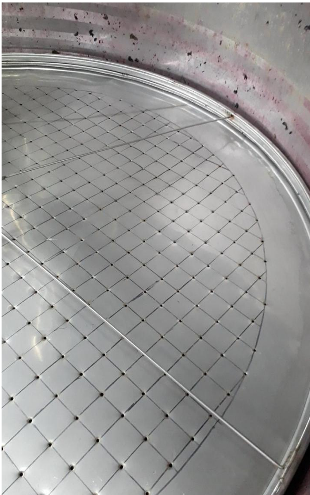
Figura A4. Detalle del sistema de retención del sombrero en el tratamiento de maceración con sombrero sumergido (MSS), mostrando la placa perforada utilizada para mantener la fase sólida sumergida durante la fermentación.
