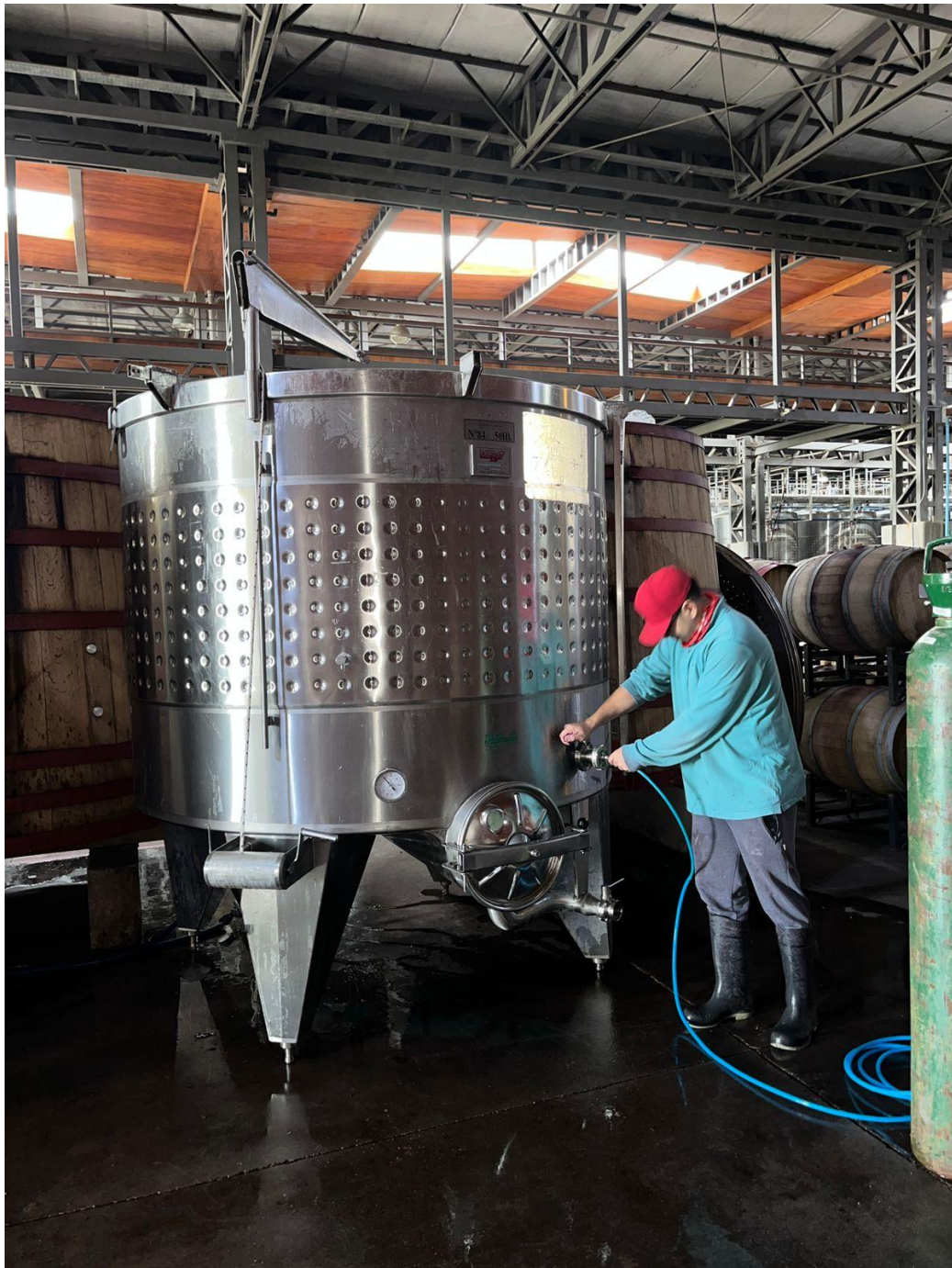
Figura A2. Tanque de fermentación utilizado en el ensayo, equipado con sistema de conexión para la inyección de gas nitrógeno empleado en la homogeneización del medio durante la maceración con sombrero sumergido.
