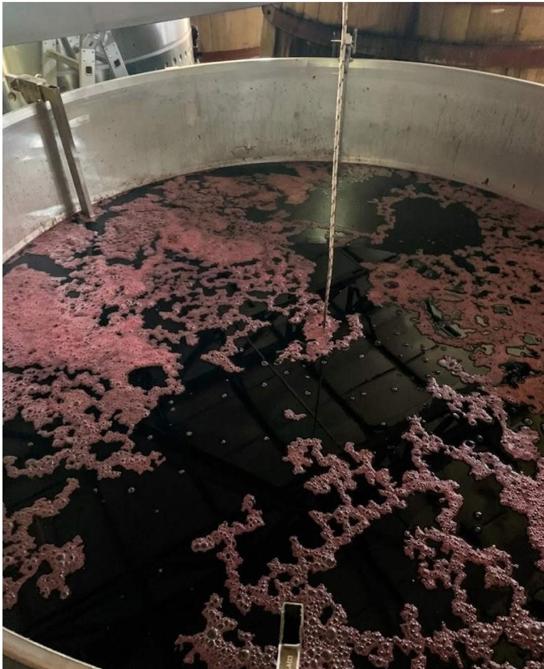
Figura A5. Superficie del mosto durante la fermentación alcohólica en el sistema de maceración con sombrero sumergido (MSS), evidenciando la ausencia de sombrero flotante y la presencia de una fase líquida continua sobre el sistema de retención.
