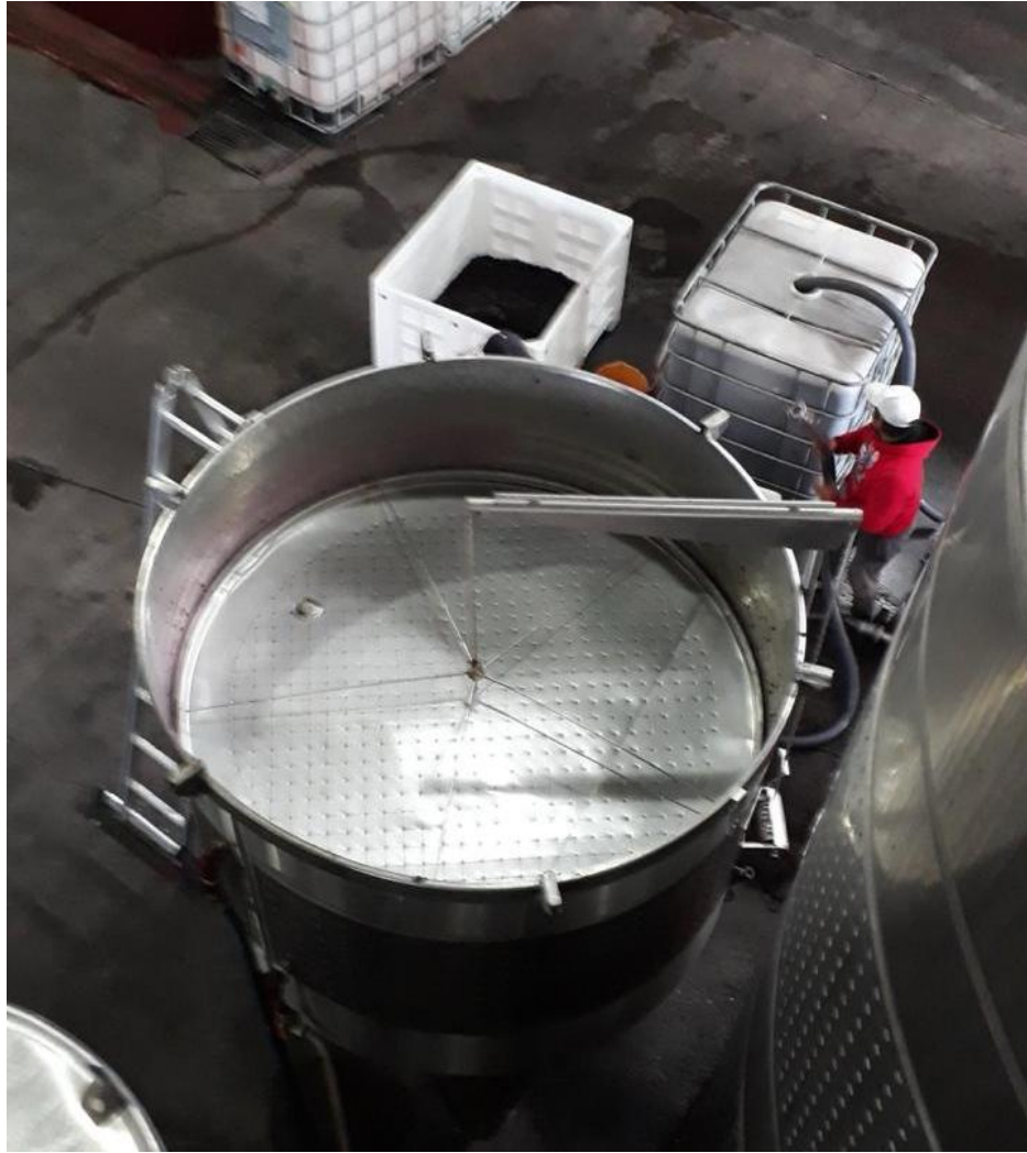
Figura A3. Sistema de maceración con sombrero sumergido (MSS) instalado en el tanque de fermentación, mostrando el dispositivo de retención de sólidos que permite mantener la fase sólida permanentemente sumergida durante la fermentación alcohólica.
