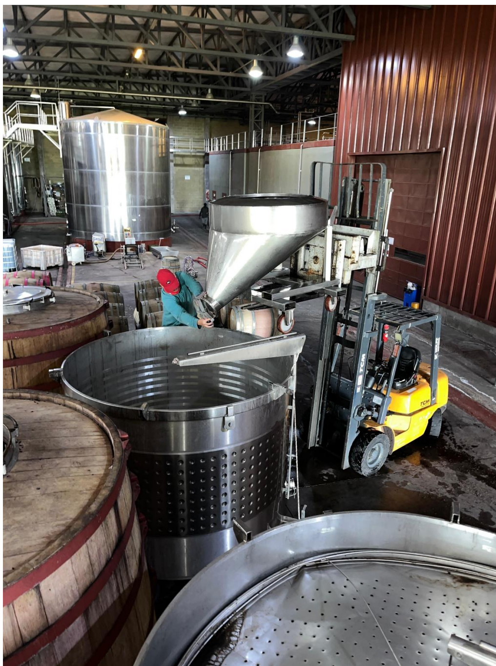
Figura A1. Operación de encubado mediante el uso de cubones de acero inoxidable, utilizada para la carga homogénea de uva en los tanques de fermentación.
