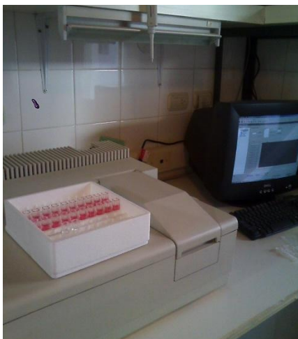
Fig. II.6. Espectrofotómetro UV-visible y cubetas utilizadas en la determinación de compuestos fenólicos y pigmentos poliméricos.
