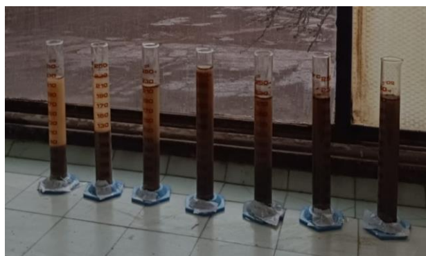
Figura 10. Ensayo de determinación de volumen de sedimentación (VS) para estimar textura aparente de suelo (Nijhenson y Pilasi, 1962). Realizada en la Cátedra de Ecología de la Facultad de Ciencias Agrarias, UNCuyo.
