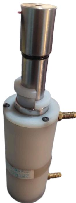
**Figura 4.2.** Sonda PC y Contenedor de muestra utilizado en el ensayo de retroextrusión.
