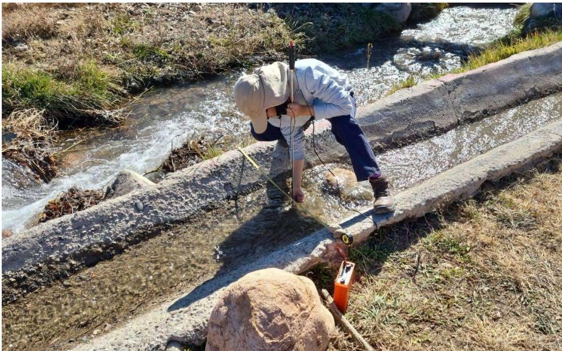
*Figura 8: Salida de campo Tunuyán, Partidor Castillo. Utilización del Micromolinete.*
