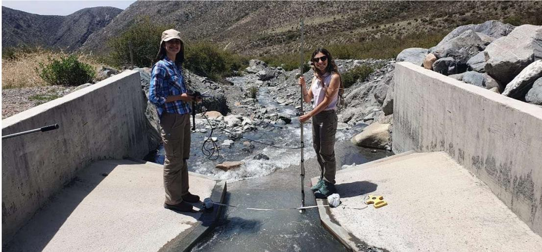
*Figura 7: Salida de campo Vallecitos. Prueba del nuevo del Molinete Electromagnético.*
