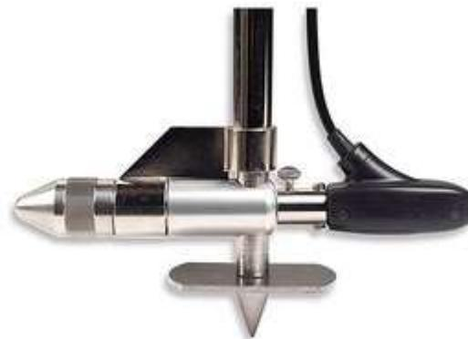
Figura 6: Molinete electromagnético.
