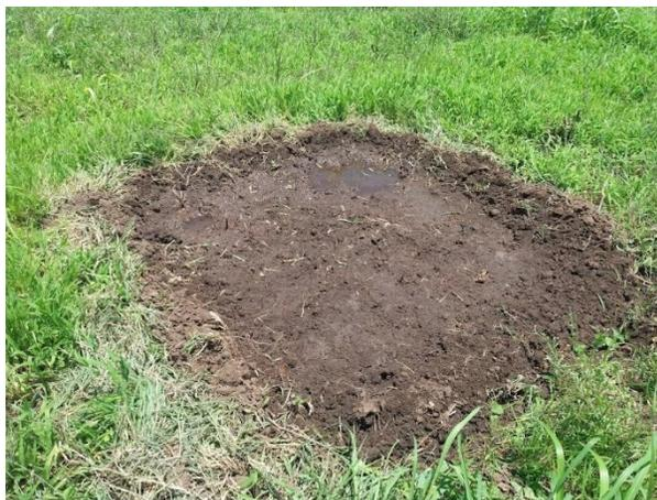
**Figura 16.** Batea preparada para realizar determinación de capacidad de campo por el método de (Grassi, 1998).
