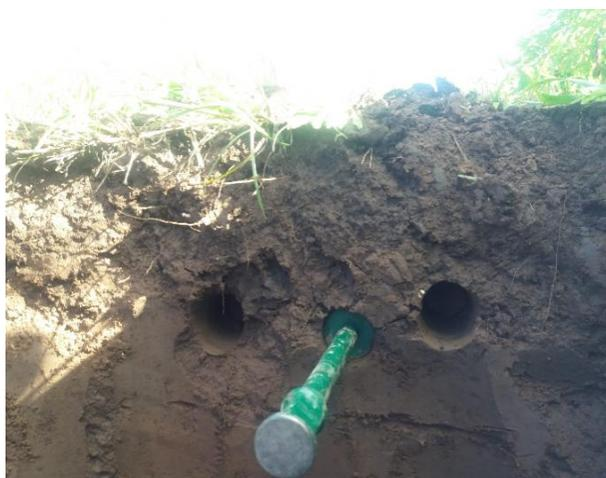
**Figura 15.** Determinación de la densidad aparente por el método del cilindro
