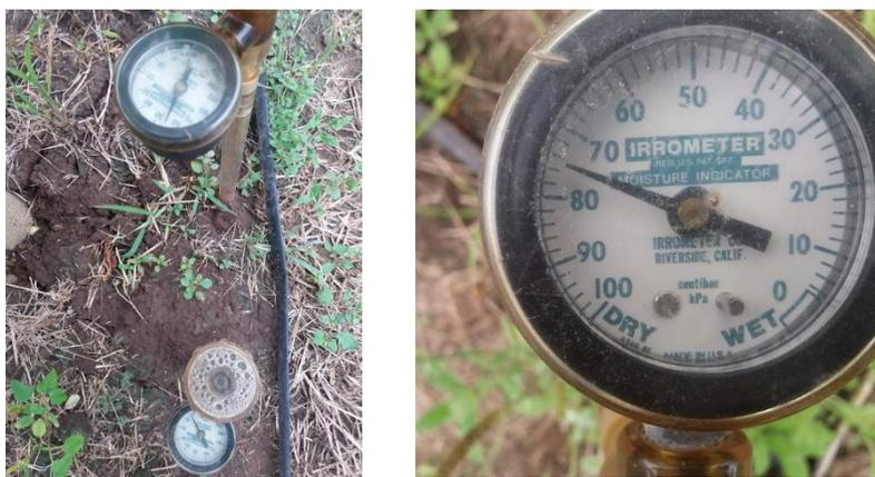
**Figura 18.** Tensiómetros ubicados en el estrato de 0 – 30 cm y de 30 – 60 cm.
