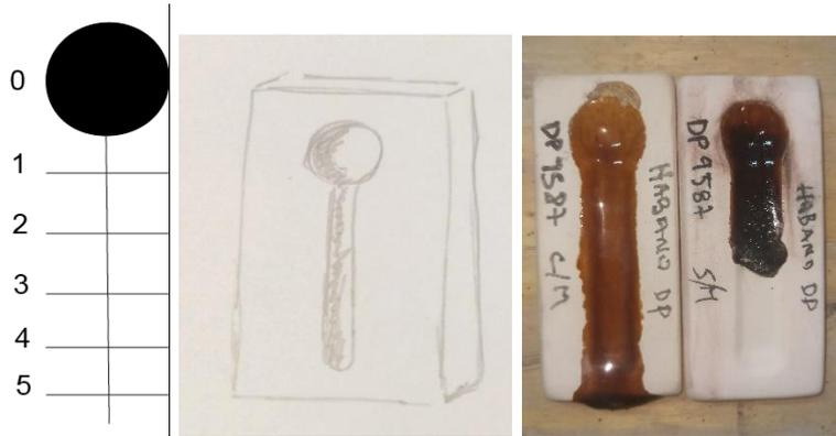
Probeta formato lagrima o termómetro utilizado para el ensayo de escurrimiento
