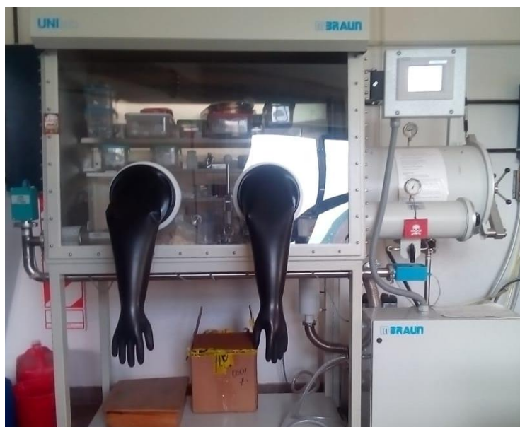
Figura 2.4. Caja de guantes MBraun Unilab utilizada para la manipulación de materiales
