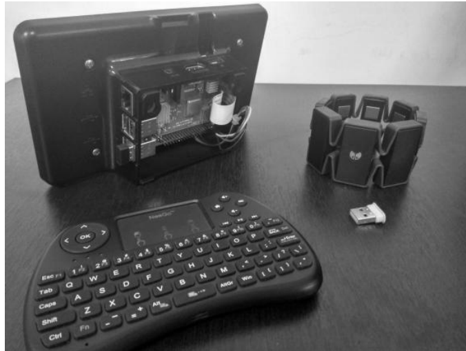
Figura 40: Interfaz MYO Armband con Raspberry Pi 3 B+.
