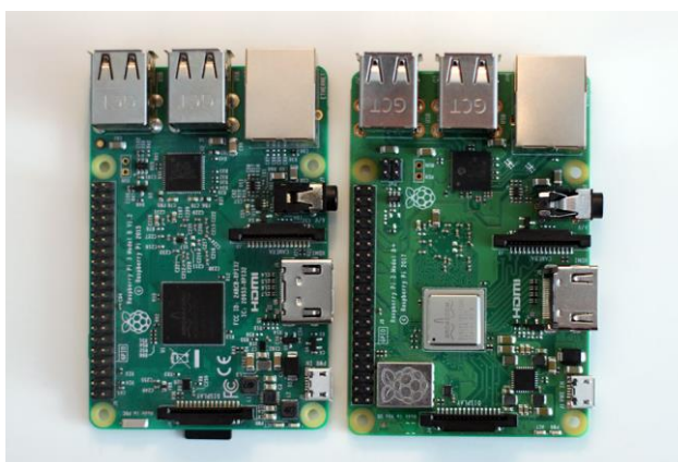
Figura 2: Raspberry Pi 3 modelo B y modelo B+.
