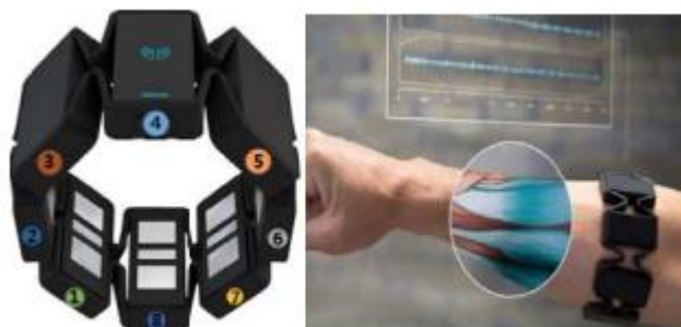
Figura 1: MYO Armband y disposición de sensores.
