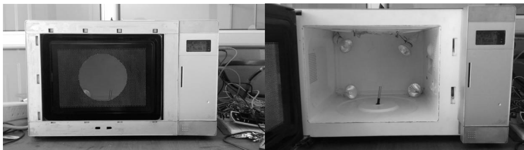
Figura 4: Vista frontal y vista interior de la cámara para control de temperatura.
