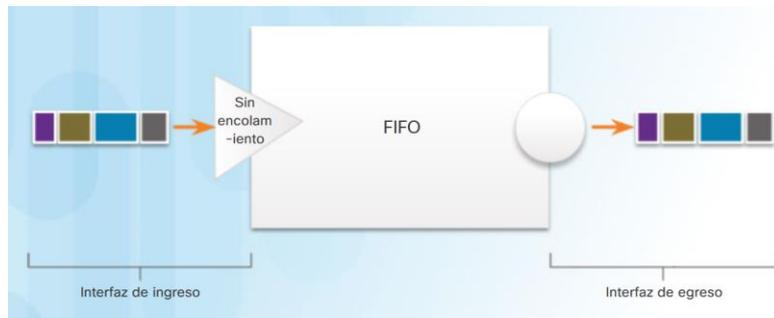
Figura 2.9. Encolamiento FIFO [Fuente: Cisco Systems]
