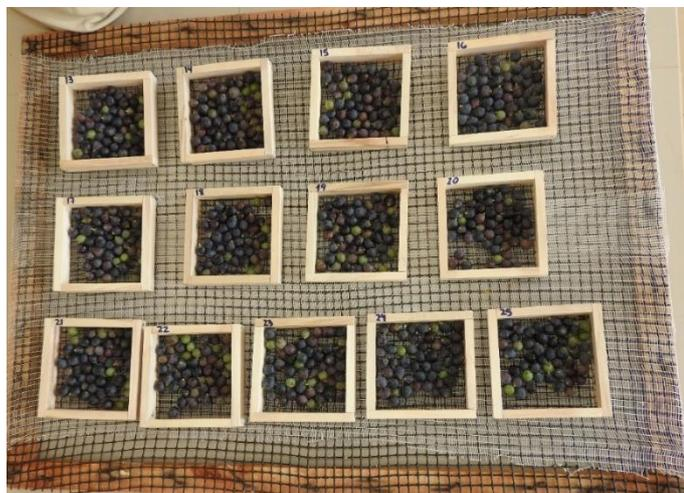
Figura 19. Bandeja de horno deshidratador con base perforada para favorecer la circulación de aire calefaccionado
