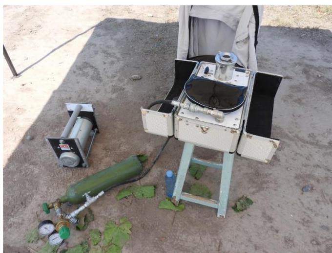
Figura 12. Cámara Schölander para medición de potencial hídrico foliar. Tanque verde es el suministro de  $N_2$ .
