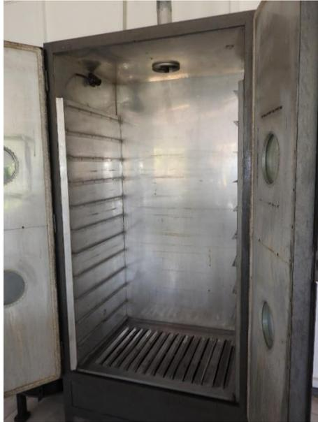
Figura 20. Horno de circulación forzada ascendente, con capacidad para 11 bandejas.
