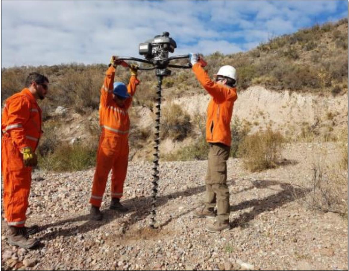
**Figura 5.** Caracterización mediante hoyadora manual en sitio. Fuente: Fundación Cricyt
