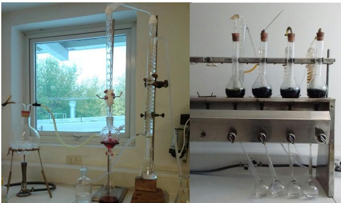
Figura 14: Equipos de laboratorio utilizados para determinaciones analíticas. Izquierda: determinación de acidez volátil; Derecha: determinación de alcohol.
