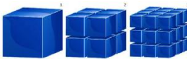
Figura 2: Aumento de la superficie específica [5] por los procesos de remoción de la roca a través de voladura u otros, de trituración y molienda. (Oyarzún et al, 2011)
