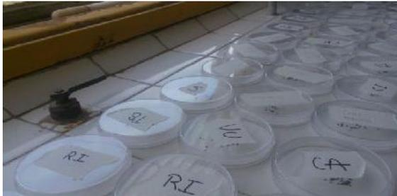
**Figura 2: Cajas de Petri con 20 semillas cada una antes de ser embebidas con la muestra de agua.**
