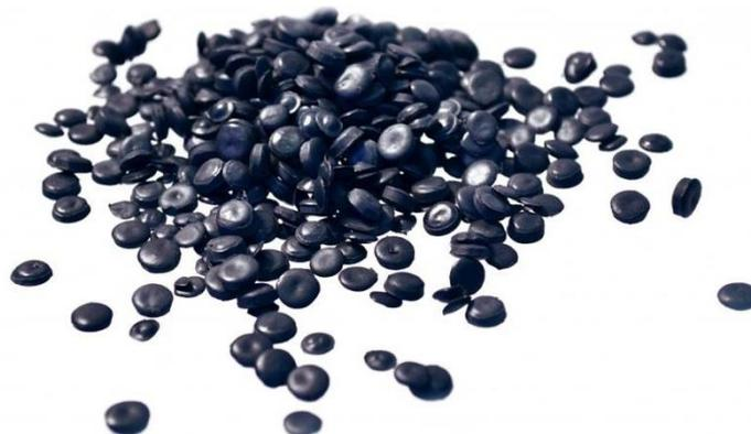
Imagen 3.1: Pellets de Polipropileno Reciclado
