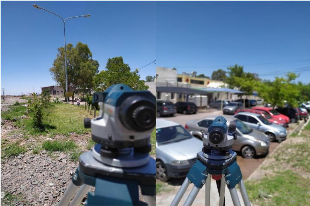
Figura 3.10.: Medición de las lecturas de niveles topográficos. Fuente: propia.
